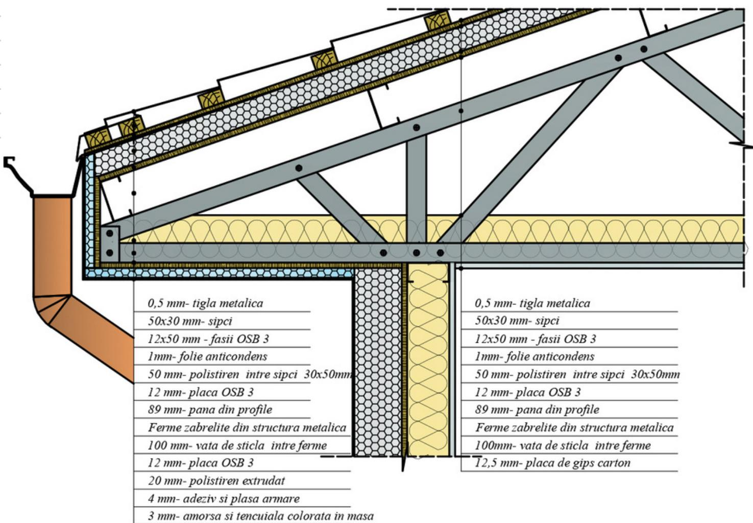
Profil cu pereti subtiri, format la rece, din tabla zincata, sectiune dreapta in forma de "C" cu marginile taiate.
